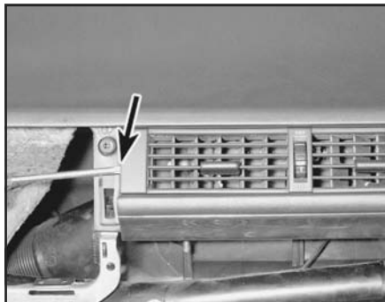
Рис. 30.14,б. ...затем выверните винт (показан стрелкой)
