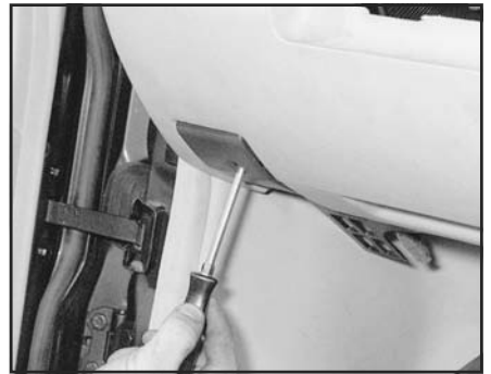
Рис. 30.12,а. На моделях с правосторонним управлением отверните винты и снимите рычажок открытия капота с нижней лицевой панели со стороны водителя
