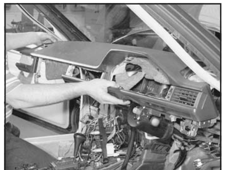
Рис. 30.16,в. ...и снимите лицевую панель с автомобиля
