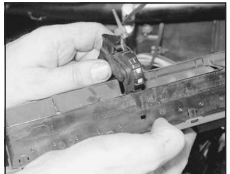
Рис. 30.14,в. ...снимите узел центральных дефлекторов, отсоединяя ручку управления, когда это станет доступно
