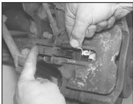
Рис. 4.3. На моделях с плавающим суппортом и одним поршнем снимите с зажимов крышку и отсоедините вилку электроразъема датчика износа
