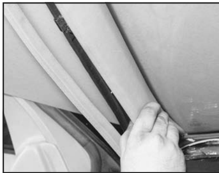
Рис. 30.13 Отделите панели облицовки левой и правой стоек лобового стекла
