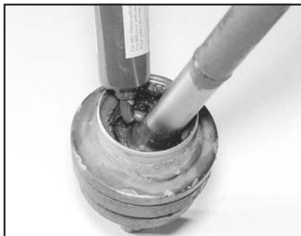
Рис. 6.15. Заполните наружный шарнир ведущего вала смазкой требуемого типа, поставляемой вместе с ремонтным комплектом
