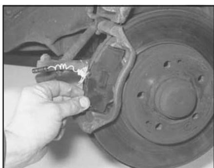
Рис. 4.6. Снимите колодки с опорного кронштейна суппорта
