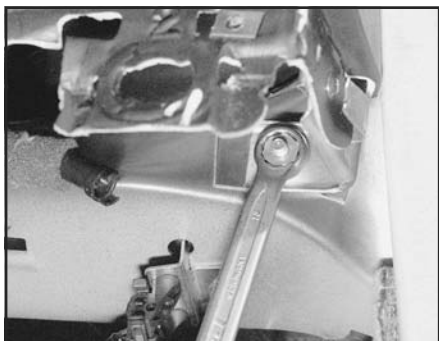
Рис. 30.16,а. Отверните гайку от края лицевой панели со стороны водителя...
