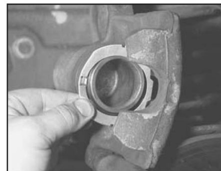
Рис. 4.5. Отверните суппорт от диска и снимите прокладку с поршня
