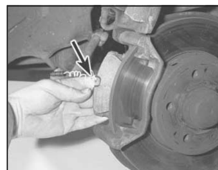
Рис. 4.12. Колодку с датчиком износа (показан стрелкой) нужно установить на место внутренней колодки
