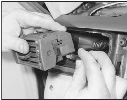
Рис. 30.11,б. ...вытащите дефлекторы с лицевой панели, отделяя их от лампочек подсветки
