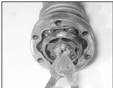
Рис. 6.5. Извлеките стопорное кольцо и выемите или вытяните внутренний шарнир с торца ведущего вала
