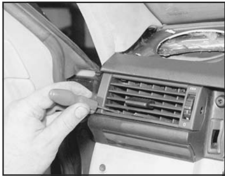
Рис. 30.11,а. Отожмите фиксаторы...
