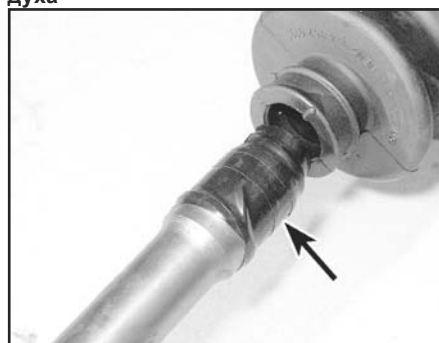
Рис. 6.18. Наденьте новый внутренний чехол. Затем удалите предохранительную ленту (показана стрелкой)
