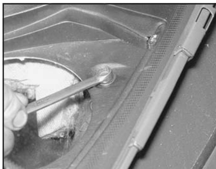
Рис. 30.16,б. ...затем отверните крепежные болты, расположенные в проемах под громкоговорители...
