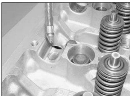
Рис. 9.12,а. Смажьте посадочные места в головке цилиндров чистым моторным маслом...
