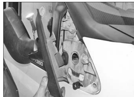
Рис. 21.4. Снимите зеркало в сборе с двери и рассоедините электрический разъем
