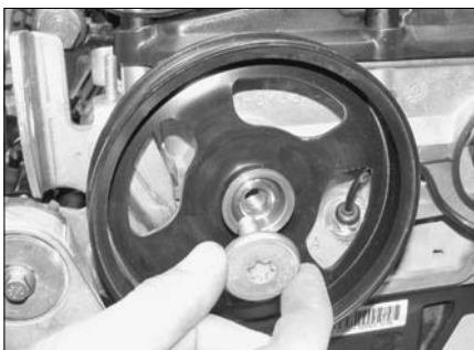
Рис. 10.2. Выверните болт и снимите шкив насоса усилителя рулевого управления
