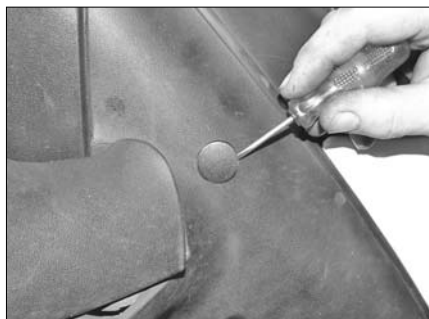
Рис. 21.2. Снимите декоративные крышки над болтами крепления основания зеркала
