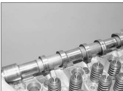
Рис. 9.12,б. ...и аккуратно опустите распределительные валы на штатные места
