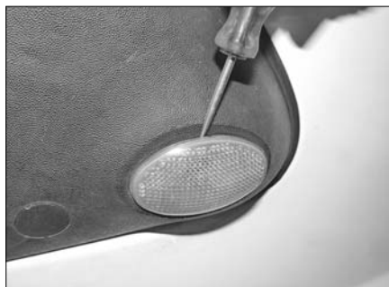
Рис. 21.1. Аккуратно извлеките боковой повторитель указателя поворота из обрамления зеркала
