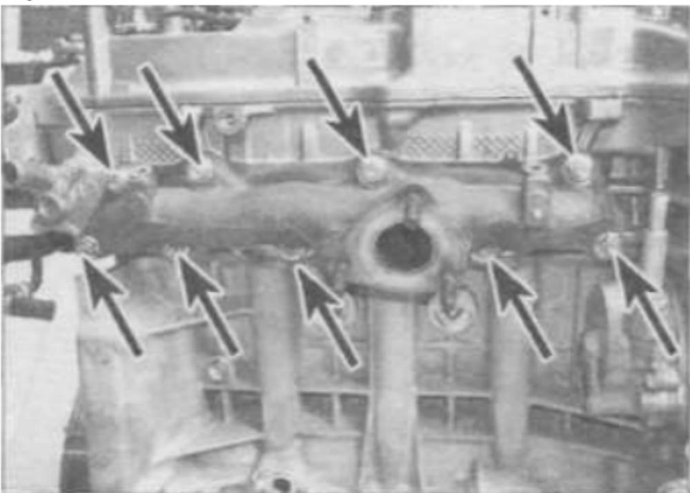
**Рис. 14.2. Отверните гайки крепления выпускного коллектора (указаны стрелками)**
