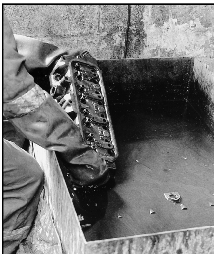
После обезжиривания головки в растворе каустической соды...
