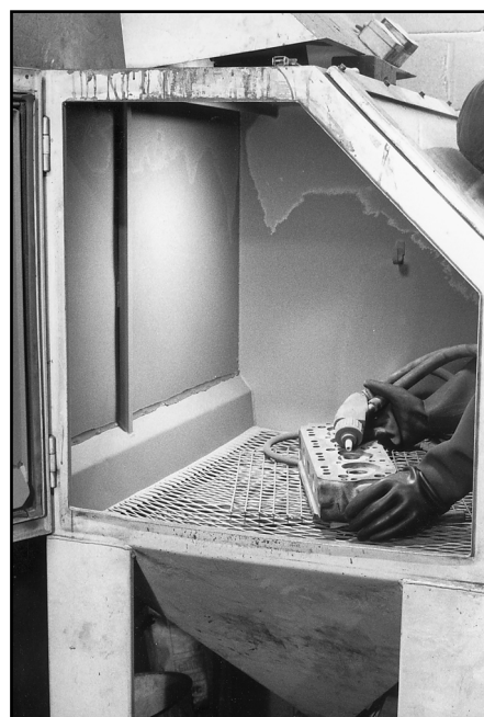
... и провести дробеструйную обработку пластиковой или деревянной крошкой (мы обычно не оставляем дверь открытой!).
