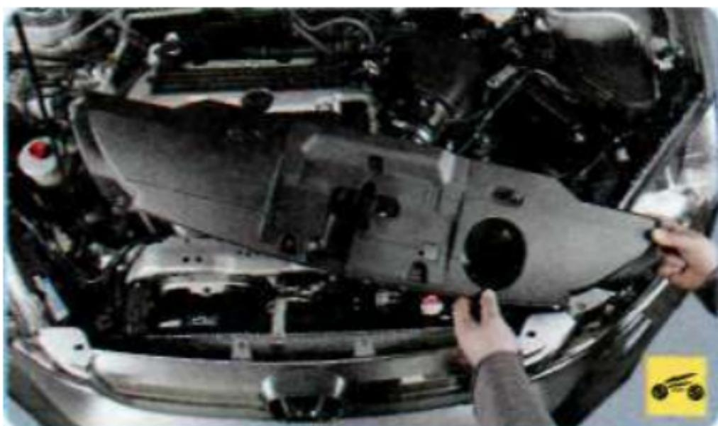
3. Снимите кожух радиатора (см. «Снятие и установка кожуха радиатора», с. 84).
