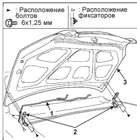
Снятие капота. 1 - трубки форсунок омывателя ветрового стекла, 2 - болты, 3 - капот.
