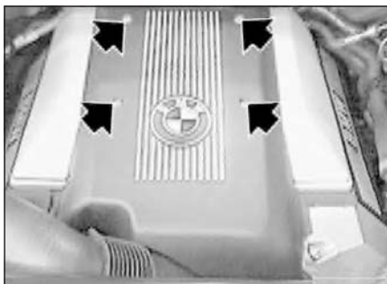
Рис. 13.5. Шумоизоляционный кожух («М62»)
