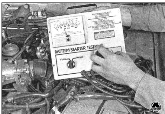
3.1c Некоторые нагрузочные вилки имеют встроенный амперметр, что позволяет точно моделировать режимы нагрузки аккумулятора (на более дешевых нагрузочных вилках имеется только выключатель нагрузки и вольтметр)
