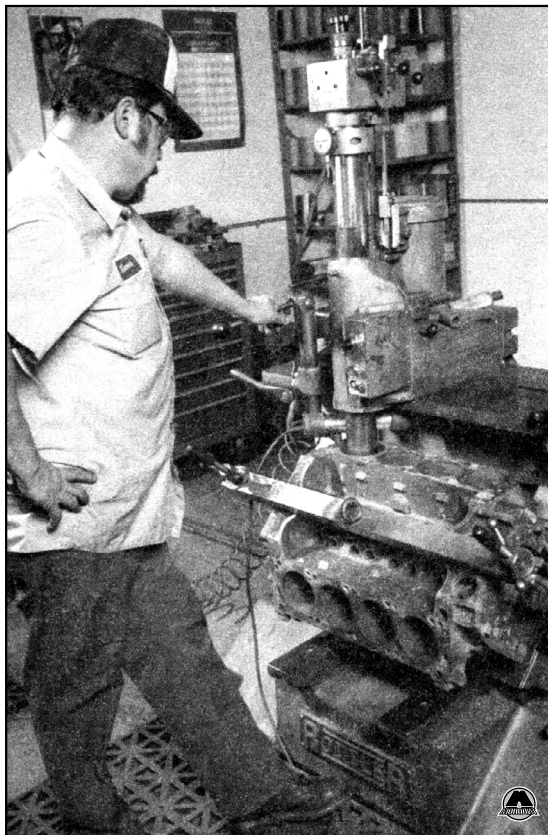
1.1 Механик производит расточку цилиндров двигателя на специальном станке
