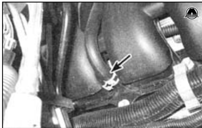
3.6 Отсоедините шланг вентиляции картера от коллектора
