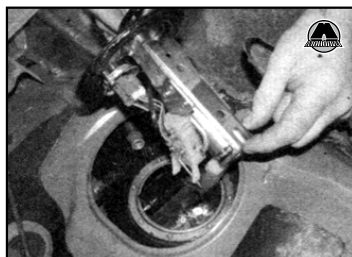
3.7 Осторожно извлеките топливный насос/передатчик в сборе из топливного бака.
