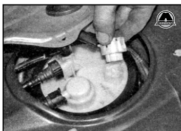
2.4 Отсоединение топливного насоса.
