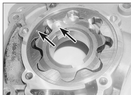
Рис. 13.18 Маркировка на роторах должна смотреть наружу из насоса
