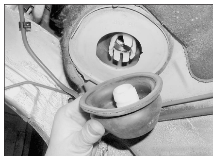
Рис. 4.25,б. Установите нижнюю часть резинового уплотнения, попросив помощника придержать верхнюю часть в салоне
