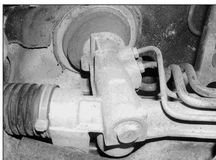
Рис. 4.23,б. Уплотнение вала рулевого механизма в полу
