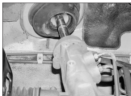
Рис. 4.23,в. Выведите вал рулевого управления из уплотнения, опуская подрамник
