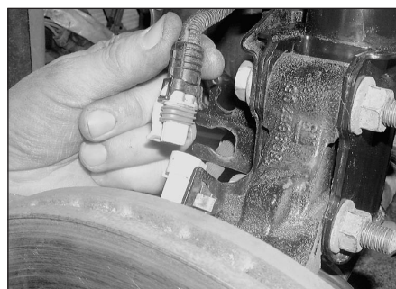
Рис. 5.4 Отсоедините проводку от переднего датчика ABS
