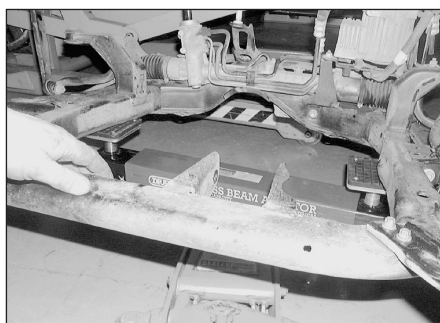
Рис. 4.23,а. Опустите подрамник вниз
