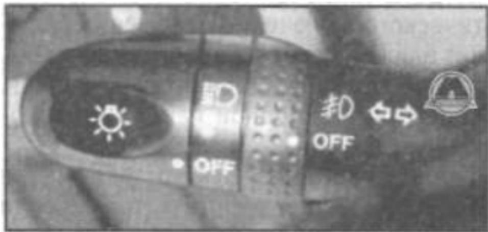
Рычаг управления наружным освещением находится с левой стороны от рулевой колонки.
