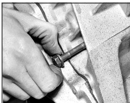
Рис. 6.6, а. Отверните болты крепления (показан уплотненный болт)...
