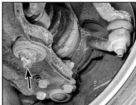
Рис. 4.2. Гайка болта с проушиной стабилизатора поперечной устойчивости (показана стрелкой)
