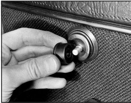
Рис. 14.5. Снятие кнопки регулятора зеркала двери
