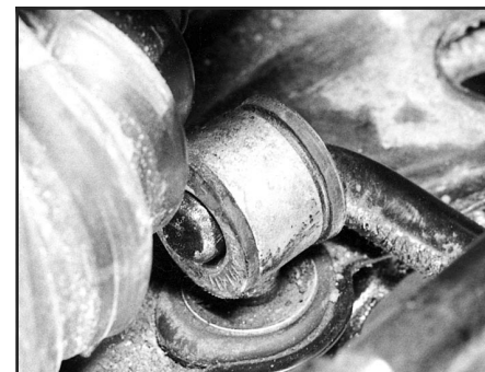
Рис. 4.5. Конец стабилизатора в проушине
