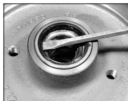
Рис. 8.3. Снятие масляной манжеты тормозного барабана
