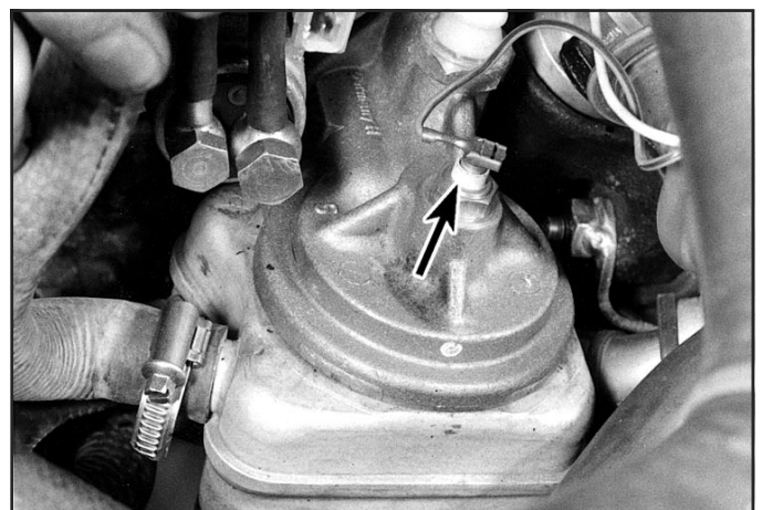
Рис. 5.39. Датчик указателя температуры масла (показан стрелкой)
