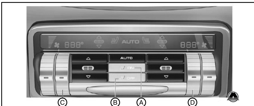
A – Включение подогрева B – Выключение подогрева C – Регулятор температуры для левого сидения D – Регулятор температуры для правого сидения
