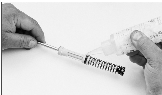
3.9г Перед сборкой цилиндра смочите все детали чистой тормозной жидкостью.
