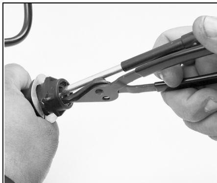
3.9а Отжав поршень главного цилиндра, снимите специальными острогубцами стопорное кольцо.
