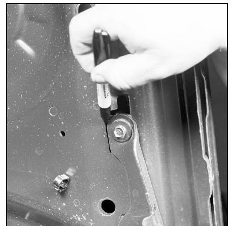
10.2 Перед снятием капота обведите петли маркером.
