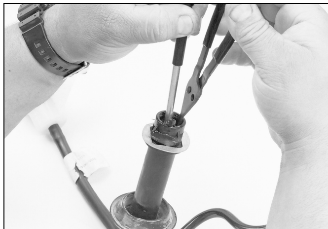
3.9д Вставив в цилиндр поршень с пружиной, сожмите пружину и установите стопорное кольцо.
