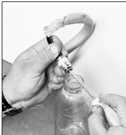
3.10б ...опустите конец трубки, присоединяемой к рабочему цилиндру, в банку с чистой тормозной жидкостью. Нажмите на шток главного цилиндра и попросите помощника открыть отвёрткой клапан фитинга, чтобы жидкость выходила из трубки.
