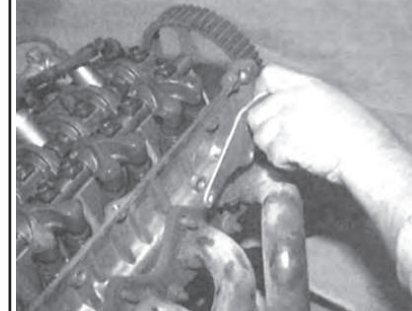
Рис. 69 Снимите подъемное ушко с коллектора...
