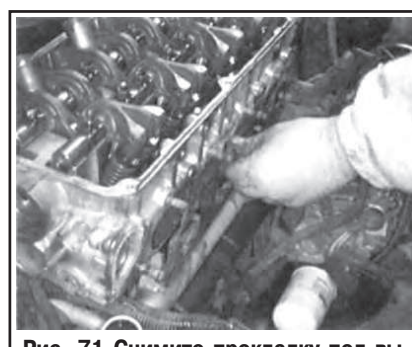
Рис. 71 Снимите прокладку под выпускной коллектор, тщательно очистите контактные поверхности и замените прокладку
