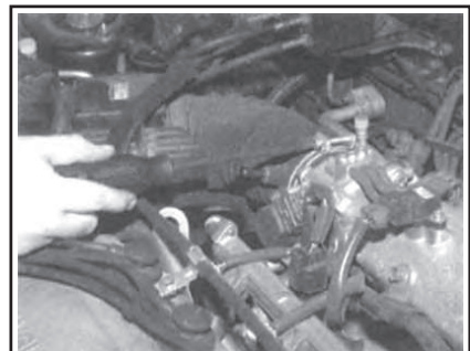
Рис. 39 Ослабьте хомут на выпускном патрубке из корпуса дроссельной заслонки...
