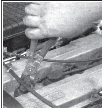
Рис. 8 Проверьте падение мощности в цилиндрах, поочередно отсоединяя провода и...
