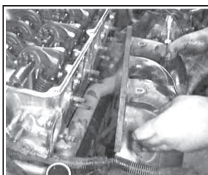
Рис. 70 ...и снимите коллектор с головки цилиндров
