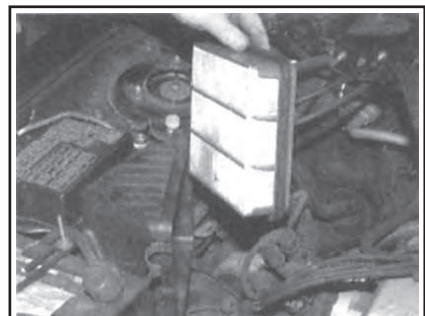
Рис. 41 Выньте фильтрующий элемент из кожуха воздушного фильтра
