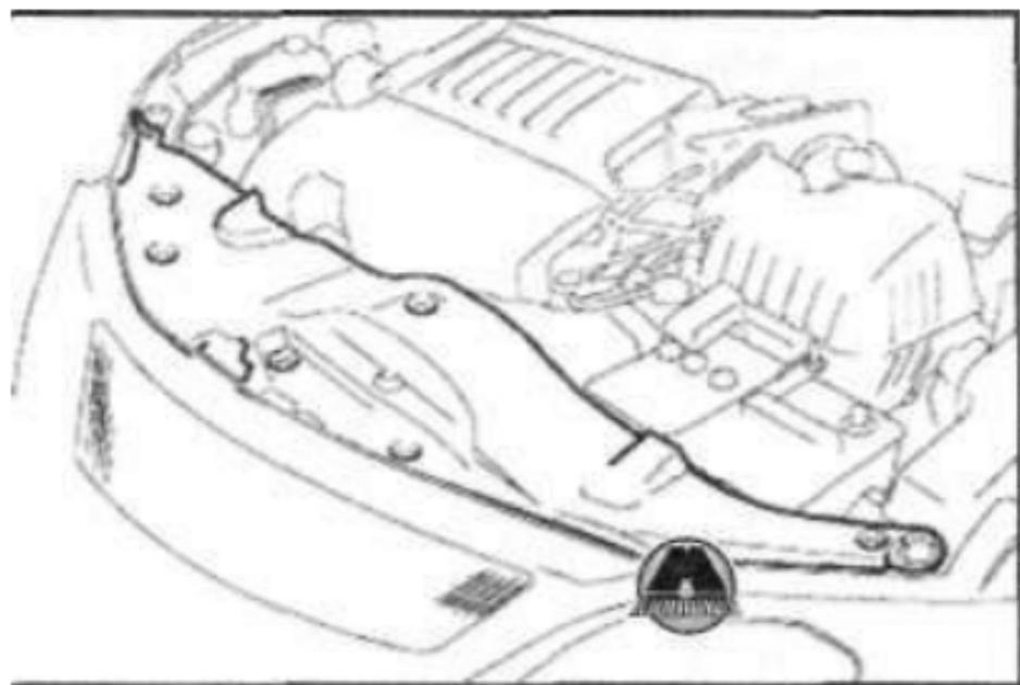
3. Снимите декоративную крышку V-образного двигателя.
