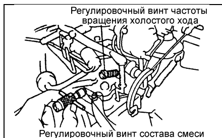
Регулировочный винт частоты вращения холостого хода
