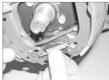
Рис. 6.7,б. ...отцепите и снимите нижнюю стяжную пружину
