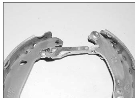
Рис. 6.9,б. ...и деталей распорки, перед тем как разобрать механизм полностью
