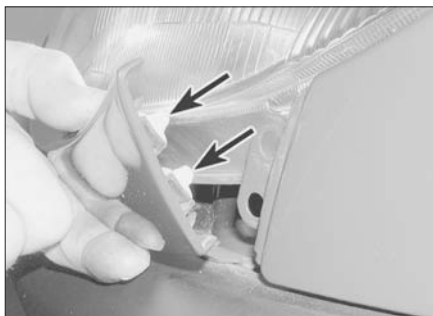
Рис. 6.3,б. ...аккуратно открепите края панели от фар, затем от крыльев...
