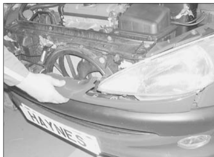
Рис. 6.3,в. ...и снимите панель с автомобиля
