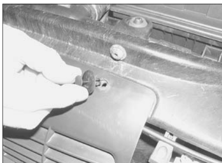
Рис. 6.2,а. Вытянув распорные сердцевинки, снимите четыре пистона, которые крепят декоративную решетку к передней панели кузова...
