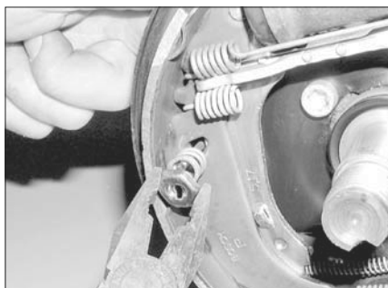
Рис. 6.6,б. Снимите чашку пружины...
