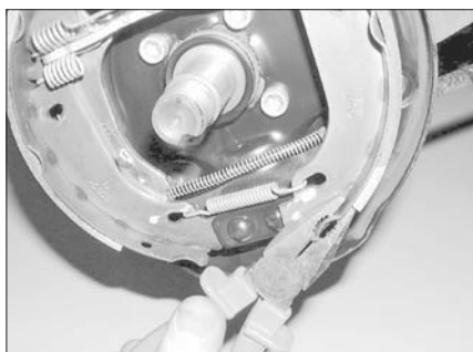
Рис. 6.7,а. Отведите колодки от нижней точки опоры...
