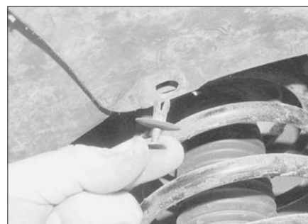
Рис. 6.5,б. ...снимите пистоны...
