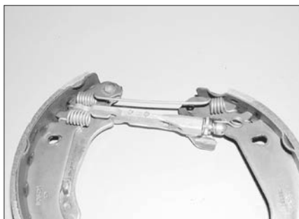
Рис. 6.9,а. Запомните положение пружин...
