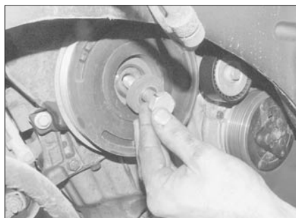
Рис. 7.18,а. Отверните болт крепления шкива коленвала...
