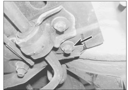
Рис. 19.8,б. Болт заднего крепления подрамника (указан стрелкой)
