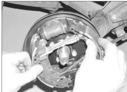
Рис. 6.8,а. Отведите обе колодки от рабочего цилиндра...
