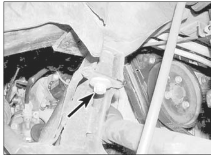
Рис. 19.8,а. Болт переднего крепления подрамника (указан стрелкой)
