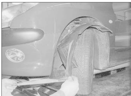
Рис. 6.5,в. ...затем выньте локер из-под арки
