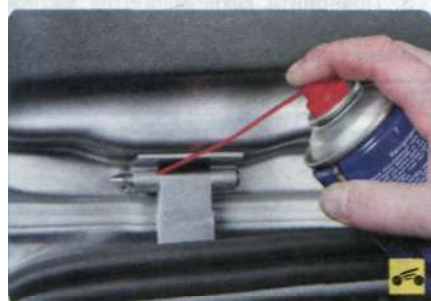
11. Петли двери задка (моторное масло).
