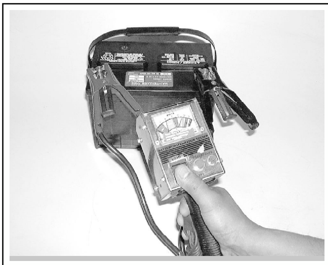
3.3. Подсоедините нагрузочную вилку к батарее и, в соответствии с инструкциями изготовителя вилки, проверьте состояние батареи под нагрузкой
