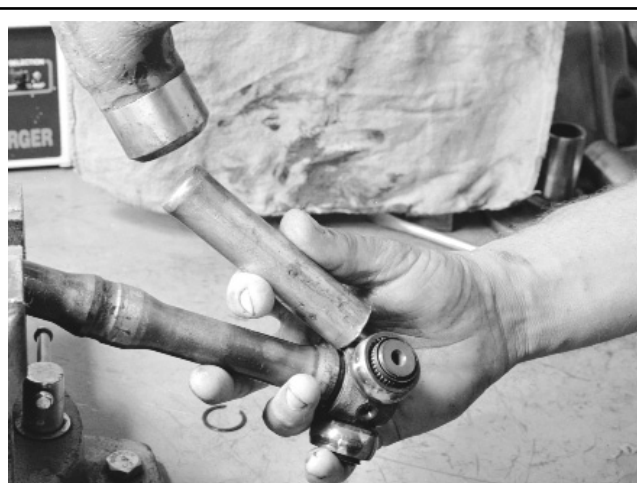
3.7. С помощью молотка и медной выколотки сбейте крестовину шарнира; не повредите на вале рабочие поверхности подшипника или шлицы
