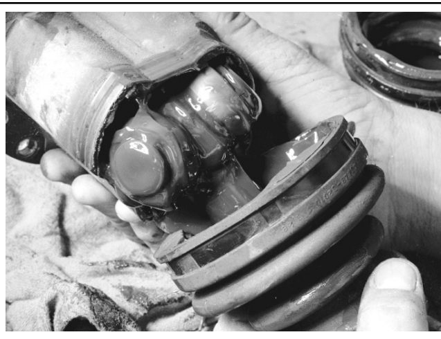
3.4. Снимите чехол с внутреннего ШРУС'а и сдвиньте его на вал
