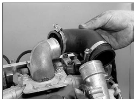
Рис. 6.4,б. ...и снимите воздуховод, соединяющий турбокомпрессор с впускным коллектором
