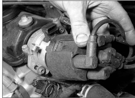
Рис. 4.6,а. Снятие крышки распределителя (показан двигатель ABD)
