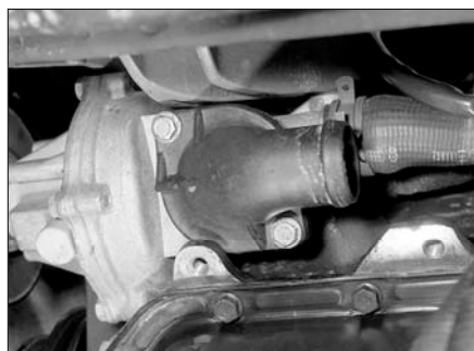
Рис. 4.10. Вверните крепежные болты и снимите крышку термостата
