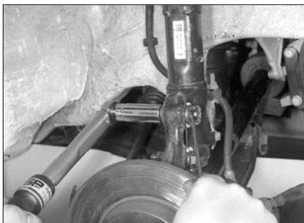
Рис. 4.23. Совместите метки, сделанные до снятия, и затяните гайки крепления стойки к поворотному кулаку
