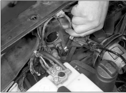
Рис. 3.8,а. Вывинчивание болта крепления радиатора
