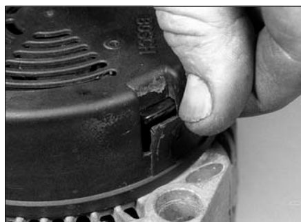
Рис. 6.3,б. ...затем отожмите фиксаторы
