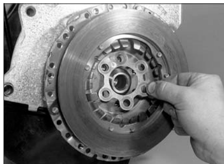
Рис. 6.15,б. ...затем установите промежуточную пластину...
