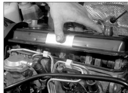
Рис. 7.4. Снимите крышку распределительного вала с головки цилиндров
