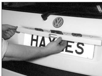
Рис. 16.4,б. ...и снимите облицовочную панель кнопки замка с двери задка...
