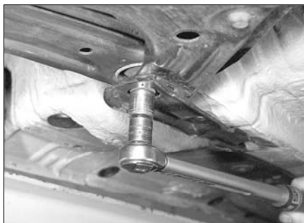
Рис. 5.11. Затяните задний болт крепления нижнего рычага моментом, предусмотренным для 1-й ступени
