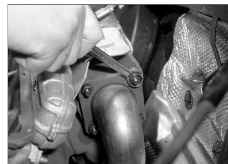
Рис. 6.7,а. Отверните гайки и отсоедините приемную трубу от выхода турбокомпрессора
