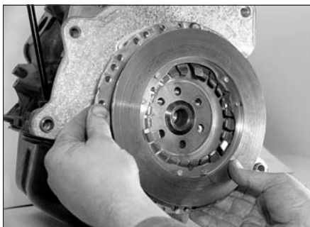
Рис. 6.15,а. Установите узел нажимного диска на фланец коленчатого вала...
