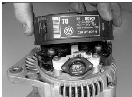
Рис. 6.3,в. ...и снимите пластмассовую крышку с задней части генератора
