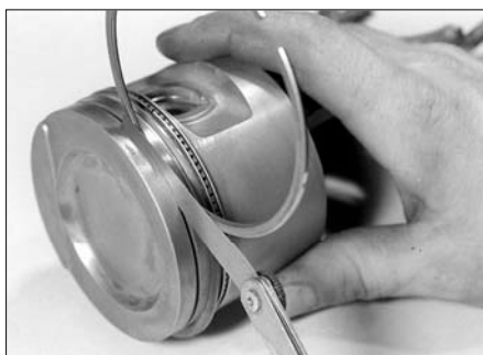
Рис. 5.19. Измерение зазора между поршневым кольцом и стенкой канавки с помощью щупа
