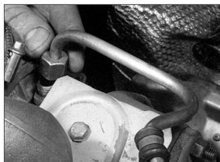
Рис. 6.6,б. Отсоединение питающего маслопровода от турбокомпрессора
