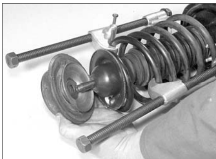
Рис. 4.19д. Установите в сборе верхнее крепление стойки...
