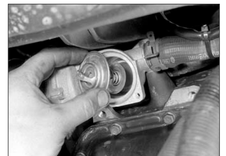
Рис. 4.11. Снимите уплотнительное кольцо и извлеките термостат из корпуса, обратив внимание на его ориентацию
