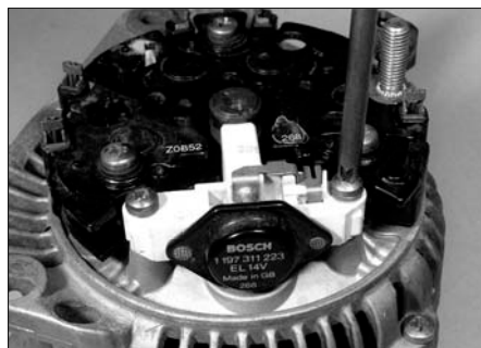
Рис. 6.4,а. Выверните винты сборки щеткодержатель/регулятор напряжения...
