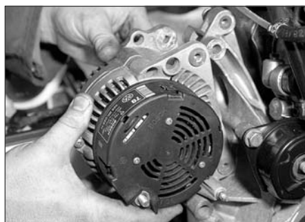
Рис. 5.5. Снятие генератора с кронштейна (показан дизельный двигатель)
