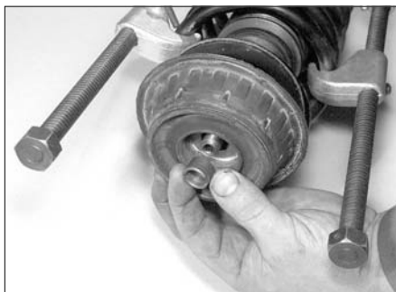
Рис. 4.19е. ...и наверните корончатую гайку на шток стойки
