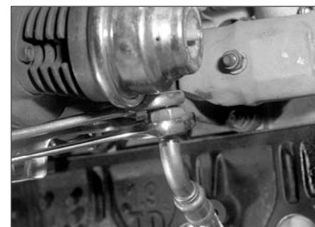
Рис. 6.6,а. Отворачивание гайки крепления возвратного маслопровода турбокомпрессора
