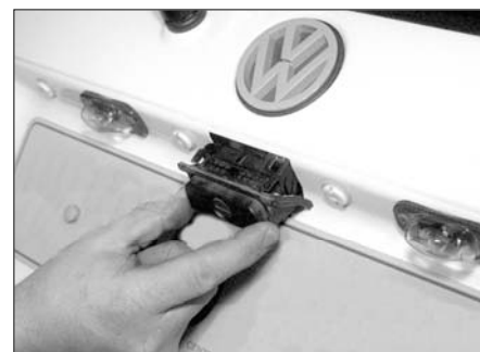
Рис. 16.5. ...затем отпустите фиксаторы и извлеките кнопку замка
