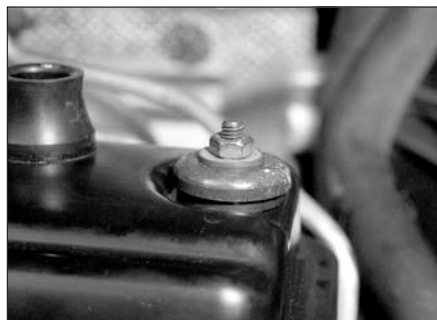
Рис. 7.3. Крепежная гайка крышки распределительного вала
