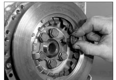
Рис. 6.15,в. ...и вверните комплект новых крепежных болтов
