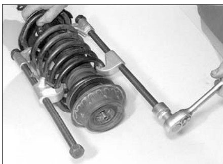
Рис. 4.19з. ...затем отпустите приспособление для сжатия, следя, чтобы концы пружины упирались в упоры на верхнем и нижнем седлах
