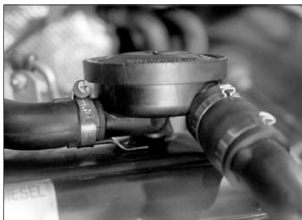
Рис. 7.2. Регулировочный клапан вентиляции картера
