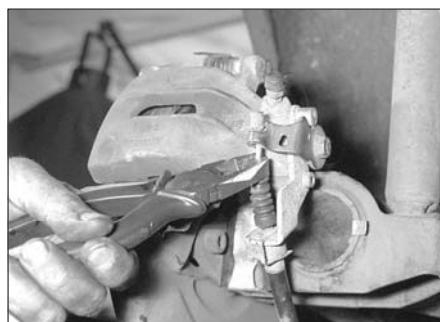
Рис. 19.7.а. Отсоедините оболочку троса от рычага суппорта дискового тормоза...
