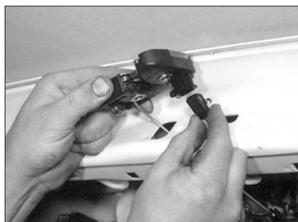
Рис. 16.1,б. ...и снимите замок, отсоединив электропроводку и тягу
