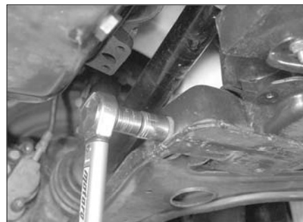
Рис. 5.14. Затяните шарнирный болт нижнего рычага требуемым моментом
