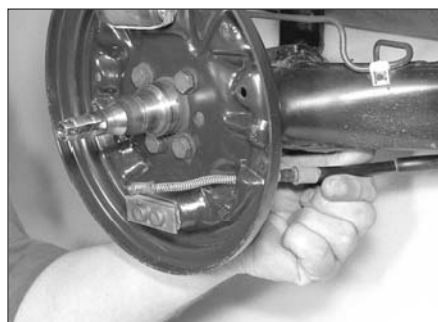
Рис. 19.6. Снимите колодки барабанного тормоза и отсоедините трос от тормозного щита
