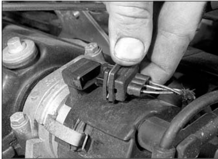
Рис. 4.5. Разъедините разъем кабеля датчика Холла на корпусе распределителя
