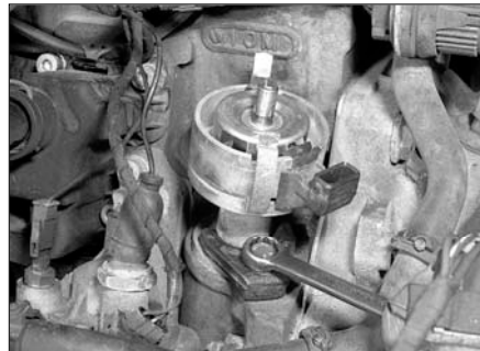
Рис. 4.9. Выверните болт, затем снимите зажимную планку (показан двигатель 2Е)
